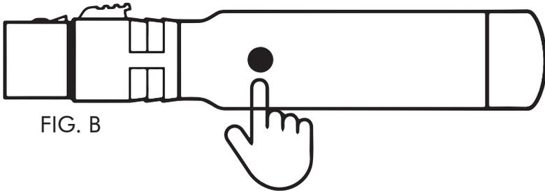
b. Presione el botón de cambio de ID en su antena receptora, seleccionando el código de color que previamente configuro en su antena transmisora. (Ej. Morado-morado, Azul-Azul, etc).
